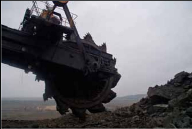
4. Koleso rýpadla Unex KU300 | Das Schöpfrad des Baggers Unex KU300 | Bucket wheel of a Unex KU300 excavator
